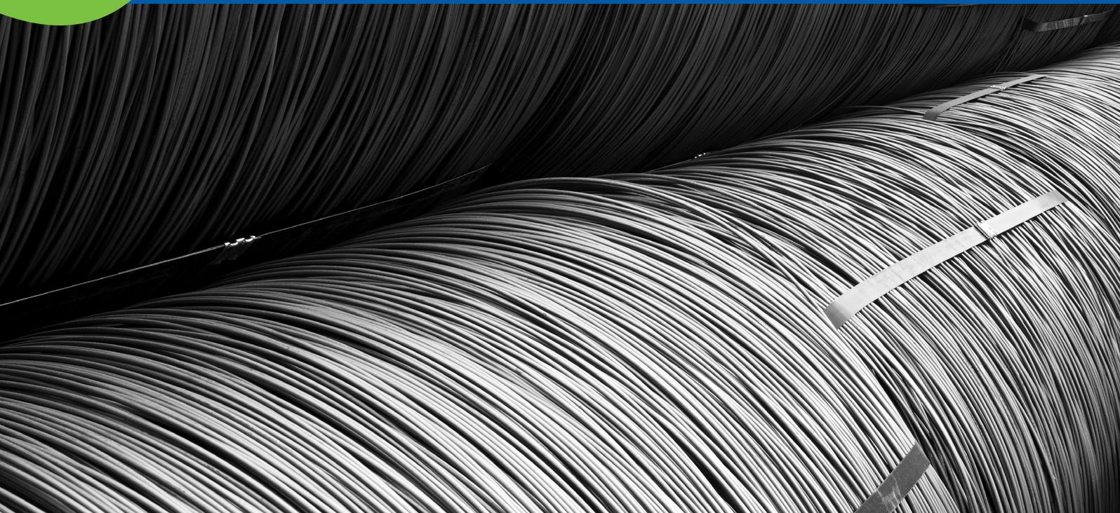
El Alambre es un producto laminado en caliente de sección maciza redonda, de diámetro o dimensión nominal no inferior a 5 mm, presentado en rollos.
