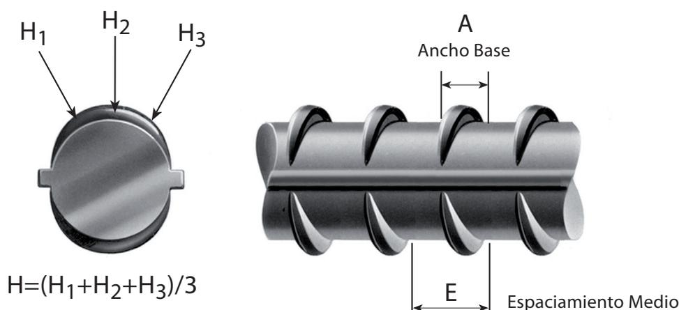
Las Barras de Refuerzo **AZA** para hormigón armado, son productos de sección circular, con nervios longitudinales y nervios inclinados respecto a su eje, en conformidad a los requisitos de la norma NCh204 Of.2020.
